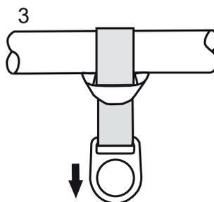
Tirar del extremo del conector suelto y ajustar.
